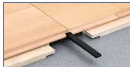
Dans la longueur, les panneaux sont connectés par rainure-langouette. Dans la largeur, une fausse languette plastique assure la connexion.
